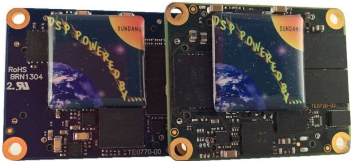
Figure 1 - The 40mm x 50 mm SoM Module for EMC 2 with Xilinx Zynq SoC
